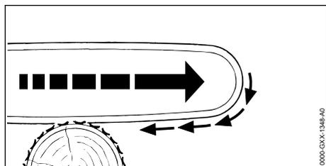
Lorsqu'on travaille avec le côté inférieur du guide-chaîne, la perche élagueuse est tirée dans le sens opposé à l'utilisateur.
