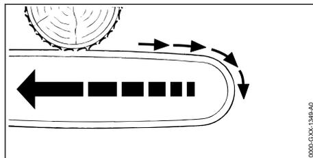
Lorsqu'on travaille avec le côté supérieur du guide-chaîne, la perche élagueuse est repoussée en direction de l'utilisateur.
