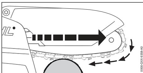
Lorsqu'on travaille avec le côté inférieur du guide-chaîne, la scie de jardin à batterie est tirée dans le sens opposé à l'utilisateur.
