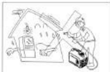
Ne connectez pas directement le générateur à un appareil électrique.
