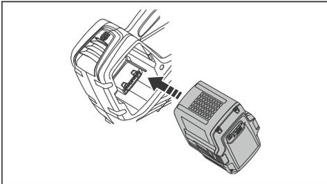
3. Appuyez sur la partie inférieure de la batterie et poussez-la complètement dans le compartiment de batterie. La batterie se fixe dans son logement, ce qu'indique le « clic ».
