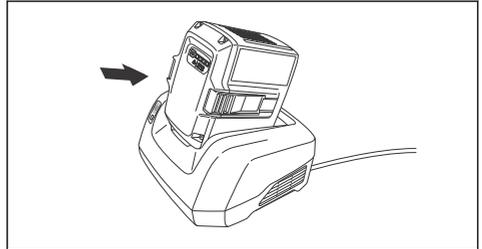
3. Assurez-vous que le témoin de charge vert du chargeur de batterie s'allume. La présence de ce témoin signifie que la batterie est correctement connectée au chargeur de batterie.
